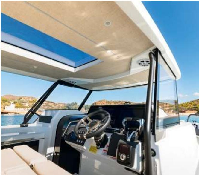
負傾窗設計能減少反射，提升惡劣天氣下的能見度，並與堅固的上層結構一同提供保護。
