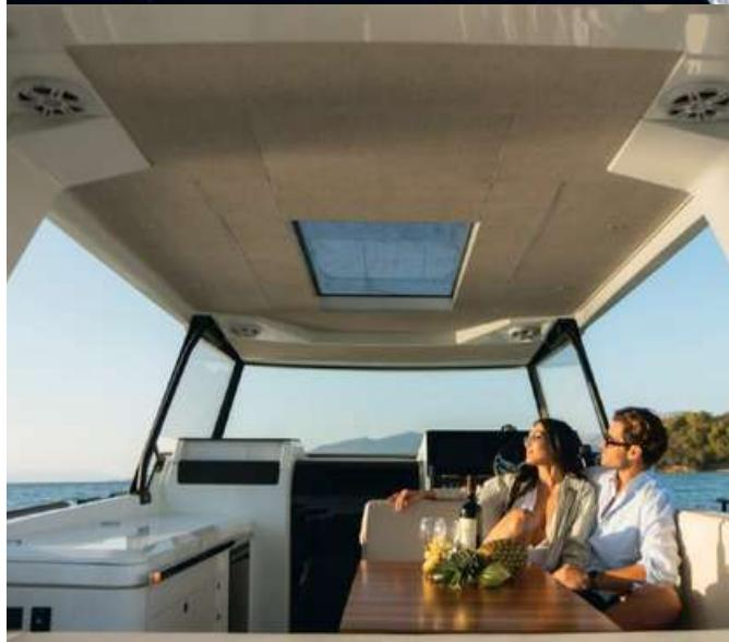
駕駛艙區域以堅固的 T 頂結構覆蓋，提供防風防雨的功能。T 頂設有一個玻璃天窗，為駕駛艙帶來充足的自然光，營造明亮的氛圍。
