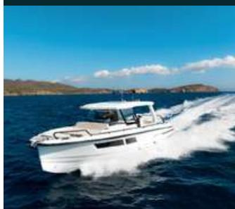
Quarken 35 GT 於芬蘭設計、製造並組裝。船體採用真空浸漿技術製造，這項技術能有效控制 GRP 厚度並確保品質一致性，製造出更強、更靈活且更輕的船體，並且降低了燃油消耗。
